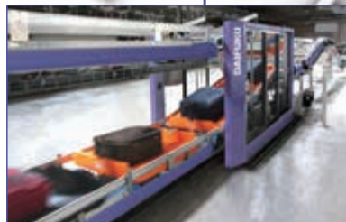
手荷物搬送・仕分けシステム
