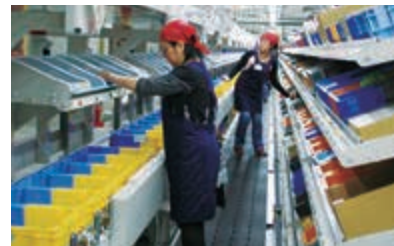
デジタル表示式デジタルピッキングシステム 「デジタルピックシステム」
