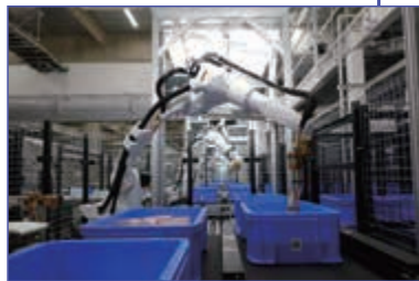
ピースピッキングロボット サイズや重さが異なるピース品をきめ細やかにピッキング
