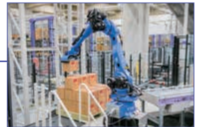
デパレタイジングロボット 自動倉庫から出庫されたパレット上の段ボールケースをピッキング
