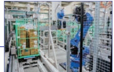
ケース積付ロボット さまざまな荷姿のケースをスピーディーに積付け
