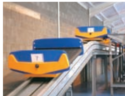
ローガン社の主力製品「チルトトレイソーター」(左)と台車システム(右)。「チルトトレイソーター」は国の内外を結ぶ中継機能を持つ空港(ハブ空港)で、乗り継ぎのための仕分けなどに多く採用されている。
