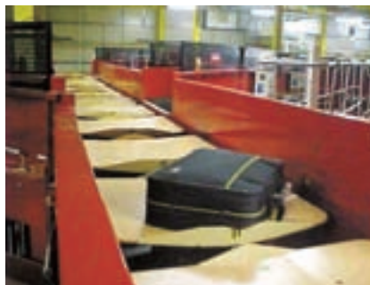
ローガン社の主力製品「チルトトレイソーター」(左)と台車システム(右)。「チルトトレイソーター」は国の内外を結ぶ中継機能を持つ空港(ハブ空港)で、乗り継ぎのための仕分けなどに多く採用されている。
