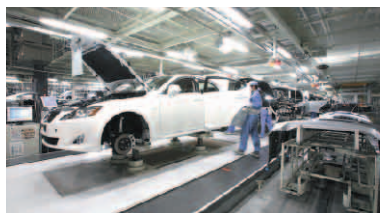
1 自動車工場向け搬送システム
