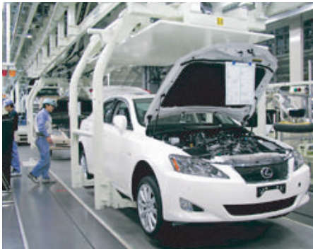
フリクション搬送システム「フレキシブルドライブシステム」
