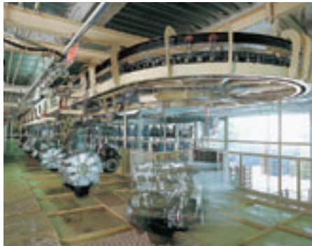
チェンコンベヤシステム「パワー&フリーコンベヤ」
