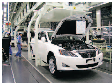
1 自動車工場向け搬送システム
