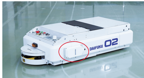
低床式AGVへの装着例(赤丸部分は受電パッド)
