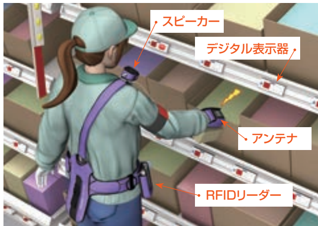
(図)ウェアラブル・ピッキングシステム「SEVEN-9」
