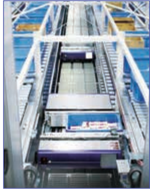
ピッキング自動倉庫 ピースピッキングを行うロボットにタイムリーに商品を供給
