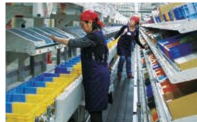
摘み取り式デジタルピッキングシステム 「デジタルピックシステム」
