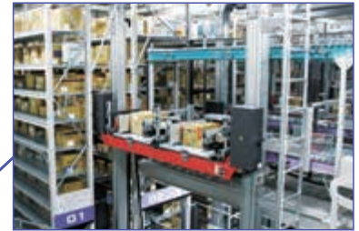
高能力ケース自動倉庫 ケース単位で出荷される異なるサイズの段ボールケースを保管
