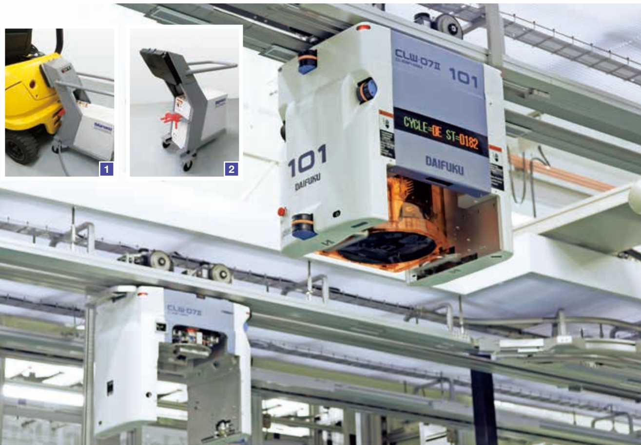
HIDを利用した半導体工場向けモノレール式搬送システム「Cleanway」
