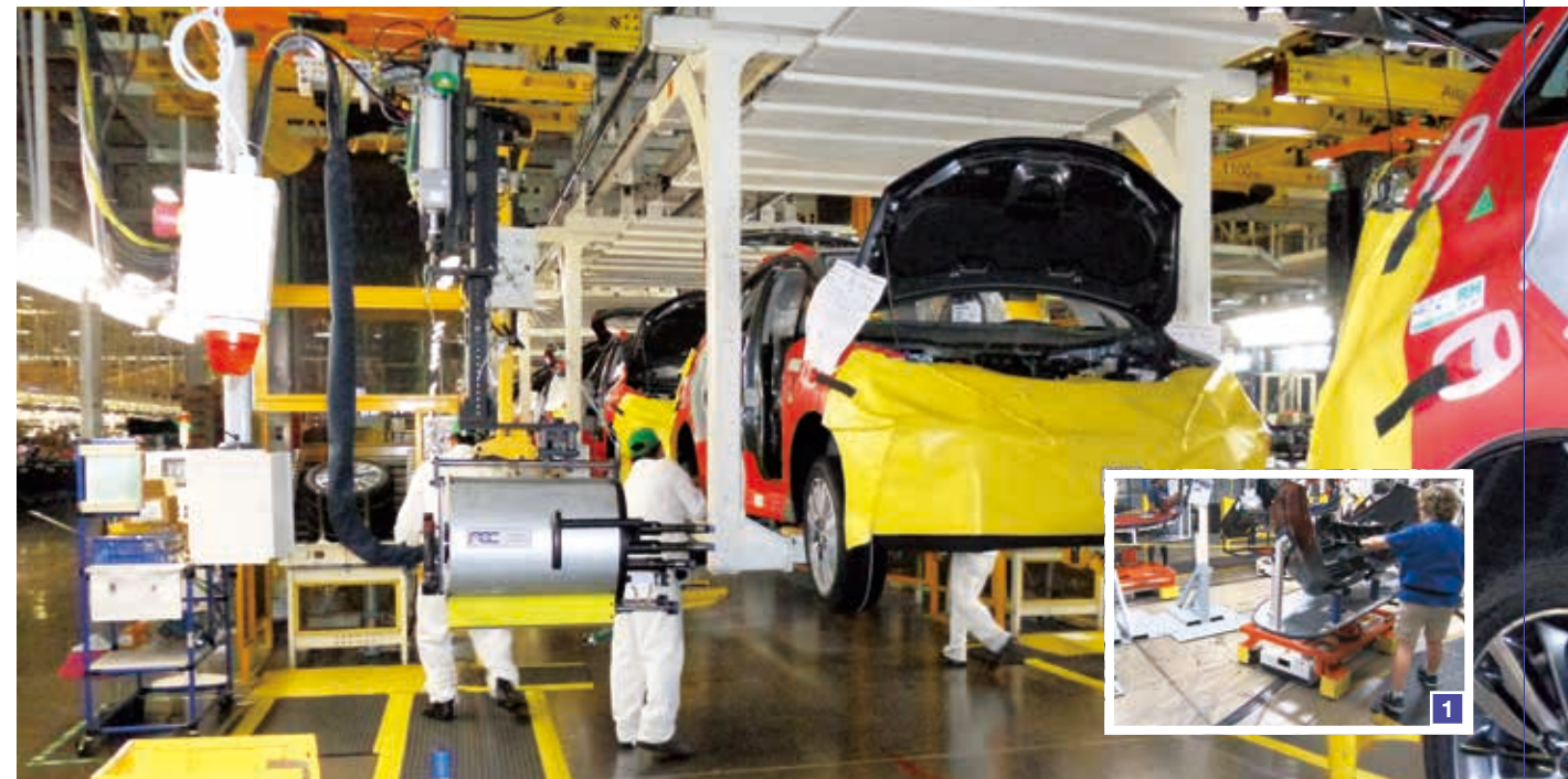
Honda de Mexico, S.A. de C.V.様組立工場のオーバーヘッドFDS
