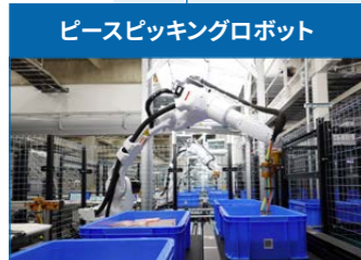
ピースピッキングロボット サイズや重さが異なるピース品を正確にピッキング
