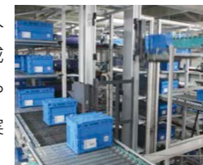
出荷用コンテナを一時保管するケース自動倉庫
