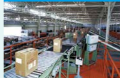
ソーティングマスター 国産初のスチールベルト式の自動仕分け機を開発
