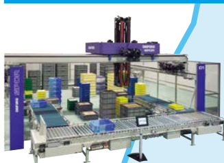
SPDR(スパイダー) 部品一時保管・仕分けシステム
