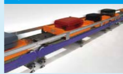
バゲージトレイシステム 搬送速度で世界最速600m/分を実現
