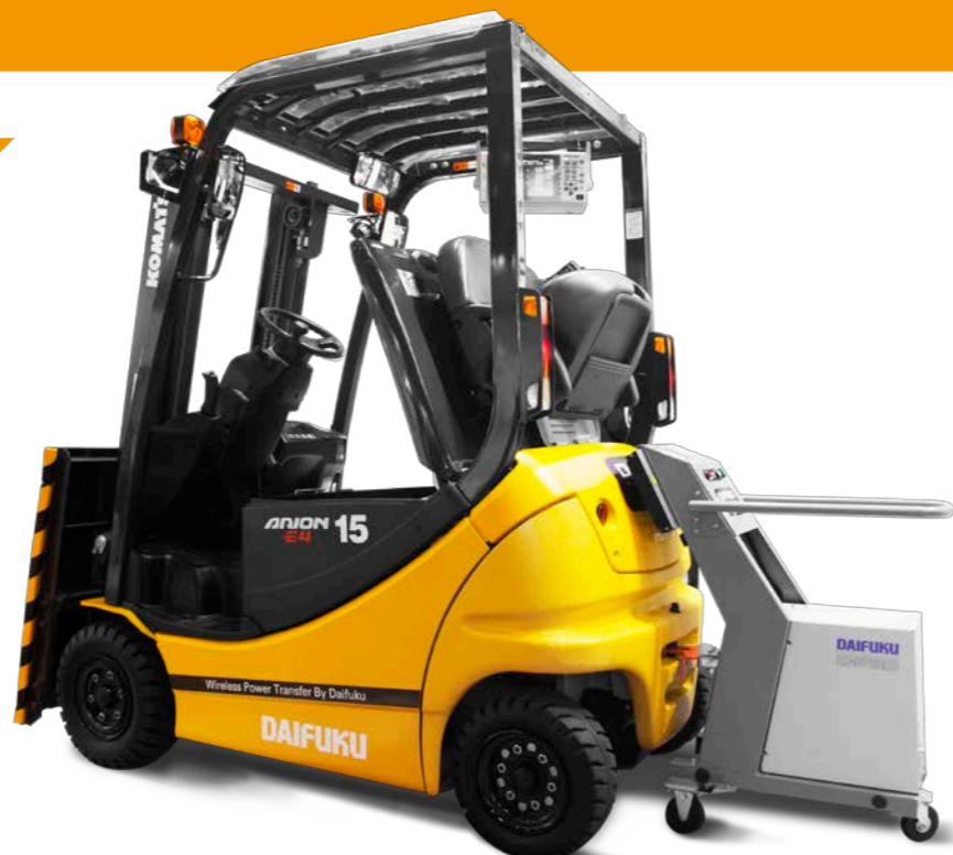
「D-PAD」を組み込んだ電動フォークリフト
