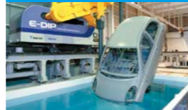
E-DIP(イーディップ) 電車搬送方式の自動車塗装システム
