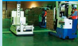
エリア管理システム 走行速度200m/分の高速ビークルをコントロール
