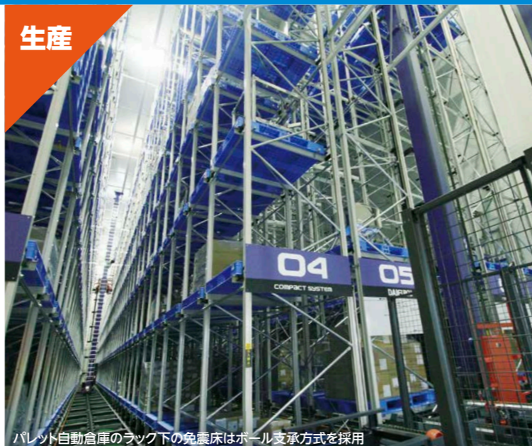
パレット自動倉庫のラック下の免震床はボール支承方式を採用
