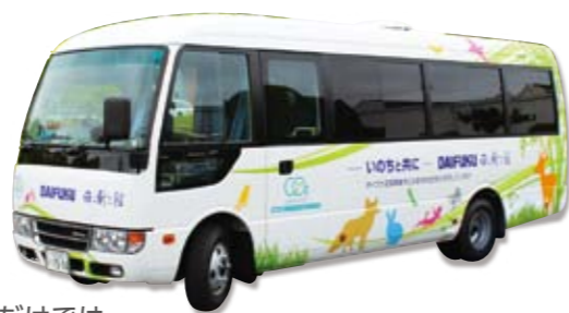
鹿天ぶら油をリサイクルした燃料で走る日に新館送迎バス。エコポイントによるカーボンオフセットの対象
