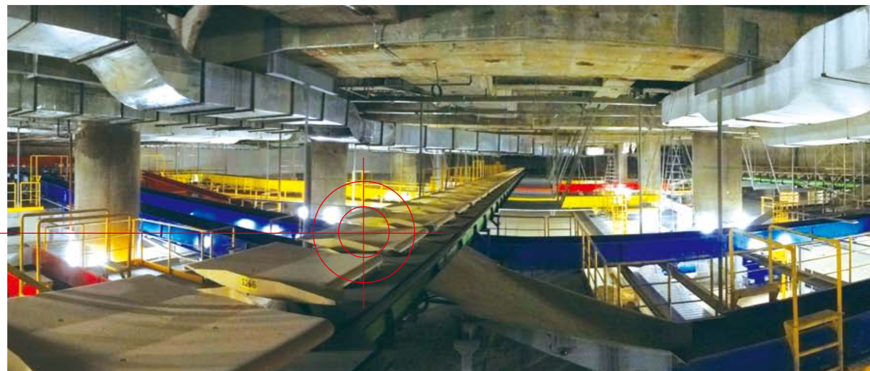
2系統・全長580m、計532トレイのチルトトレイソーター
