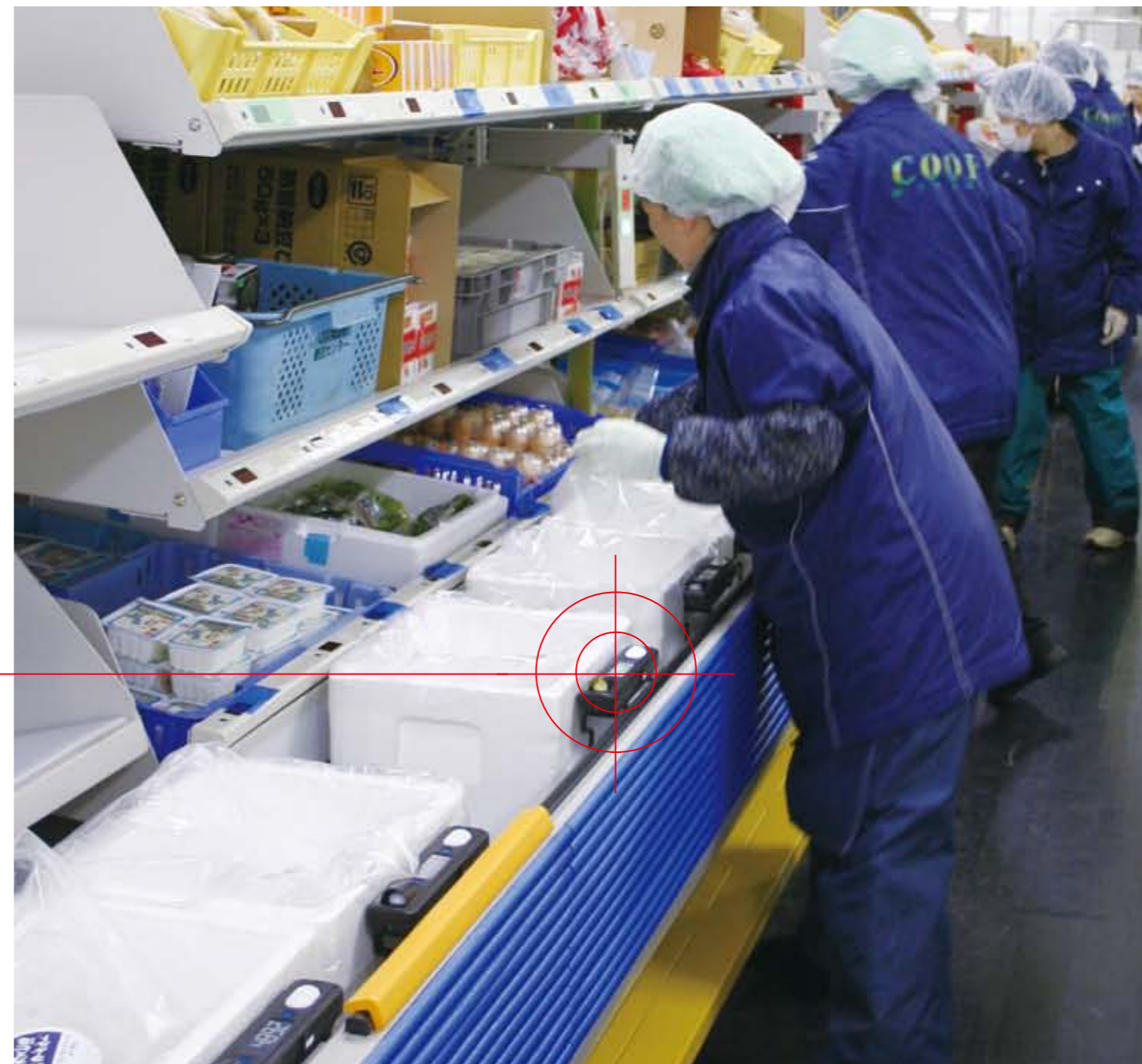
冷蔵ラインのeye-navi。棚と集品箱の表示器を連動させて集品作業を行う
