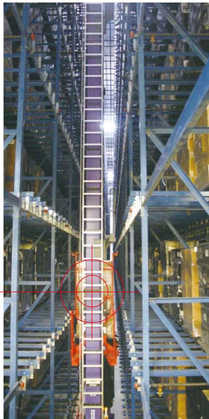
スタックークレーン12基すべてがダブルディーブタイプ
