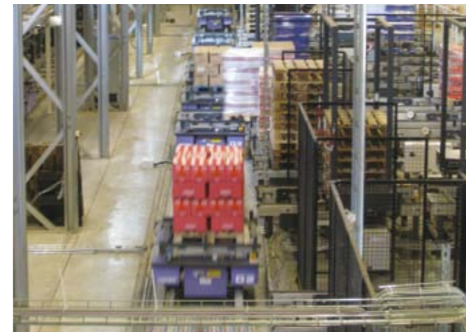
入荷商品を搬送する高速搬送台車。ループ式で29台
