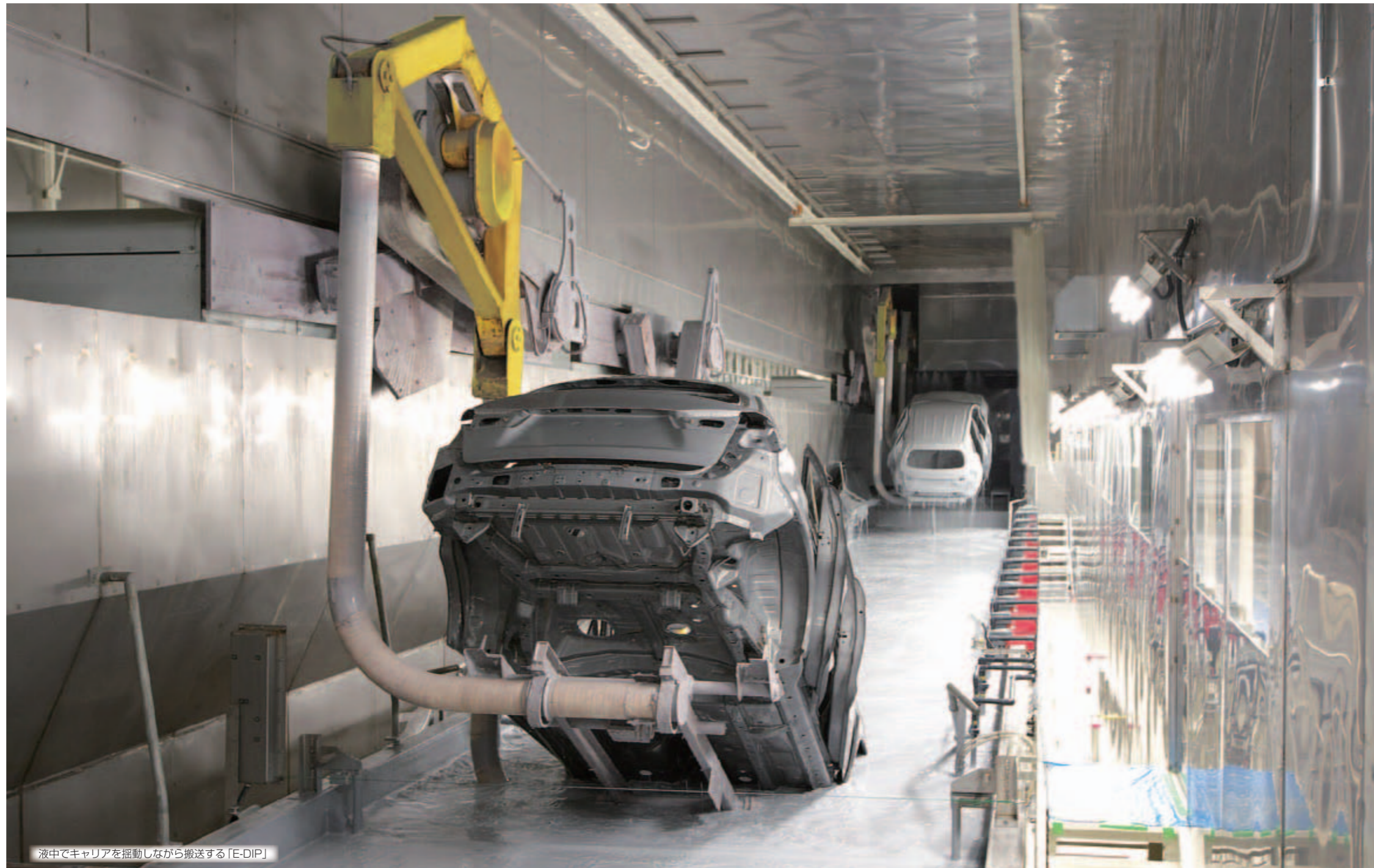
108台のボディを格納できるパレット自動倉庫「コンパクトシステム」。約1分で指示されたボディを出庫し、組立工場へ供給する。
