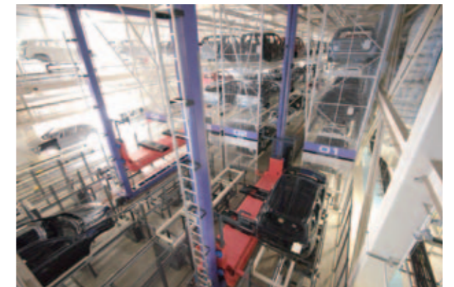
108台のボディを格納できるパレット自動倉庫「コンパクトシステム」。約1分で指示されたボディを出庫し、組立工場へ供給する。
