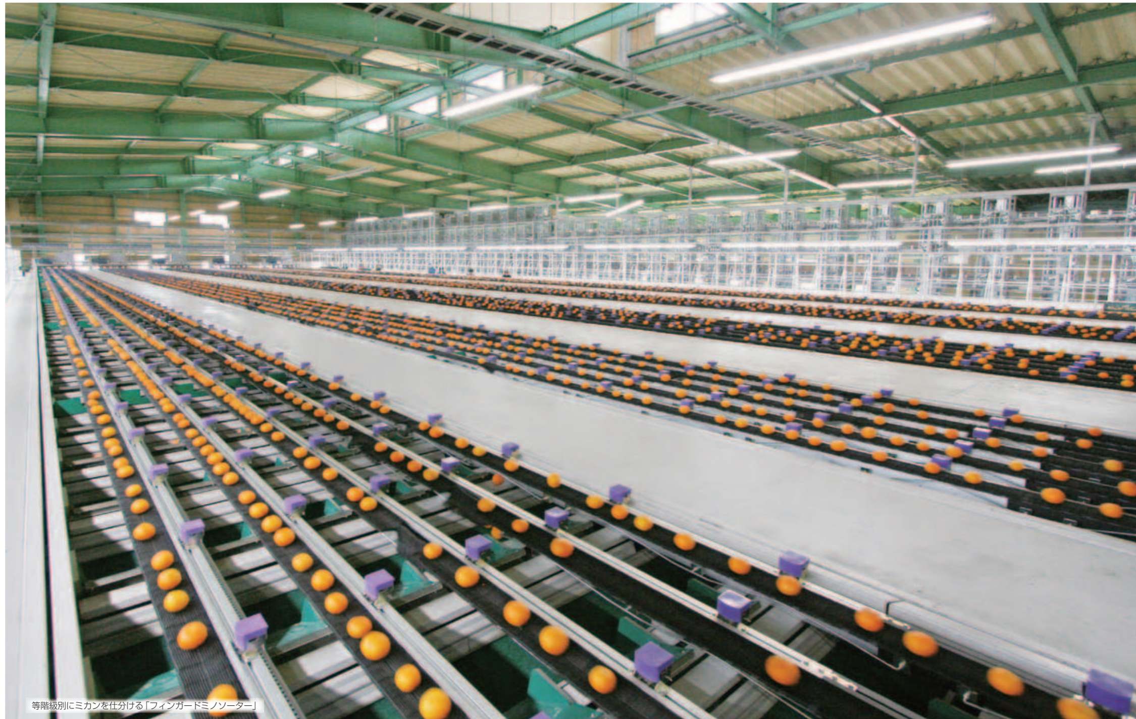
外部品質センサー。画像を瞬時に解析し、果実の形状・色・キズ・大きさを計測する。
