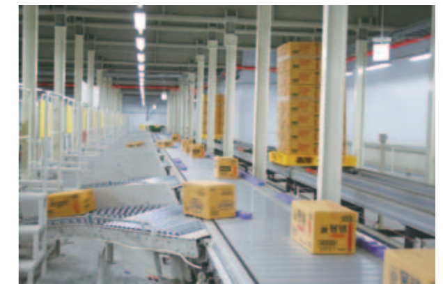
自動倉庫から出庫したケース品を出荷先別に仕分けるサーフィンソーター。
