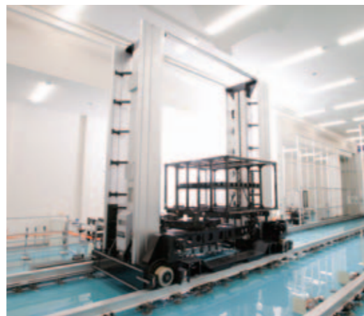
保管・搬送システム「クリーンストッカー D-6000・8000シリーズ」
