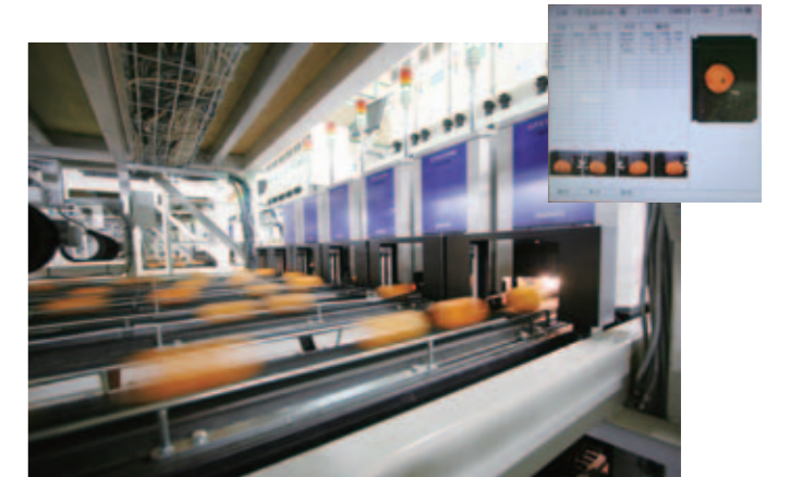
外部品質センサー。画像を瞬時に解析し、果実の形状・色・キズ・大きさを計測する。
