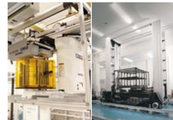
HID給電を活用した半導体・液晶生産ライン向けシステム「クリーンウェイ」と「クリーンストッカー」
