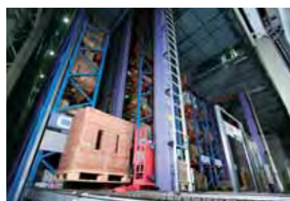
保管・補充などセンターの中核を成すパレット自動倉庫
