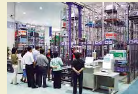
パレット自動倉庫「コンパクトシステム」
