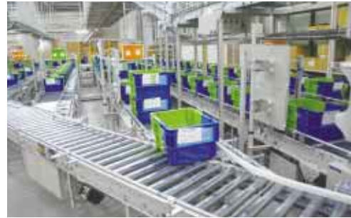
集品容器を1店舗ずつのまとまりにする整列ライン
