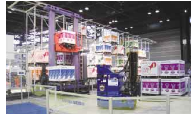
ProMat. CSの出庫に合わせて荷物をハンドリングするSmartLoader
