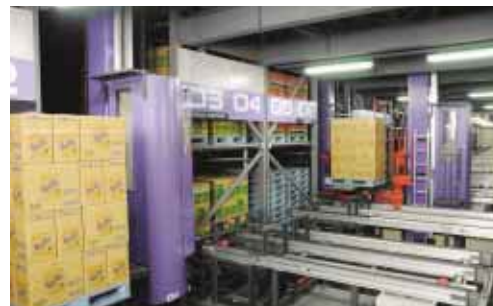
スタッカークレーン9台、総格納数3万3,408パレットの自動倉庫
