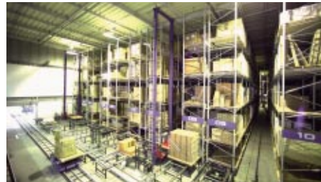
パレット自動倉庫「コンパクトシステム」
