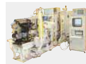
燃料を入れずにテストするモータリングベンチ
